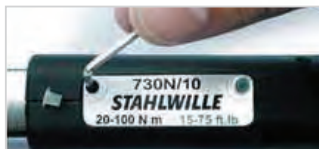
Reglare rapidă din exterior. Nu este necesară demontarea cheii.
